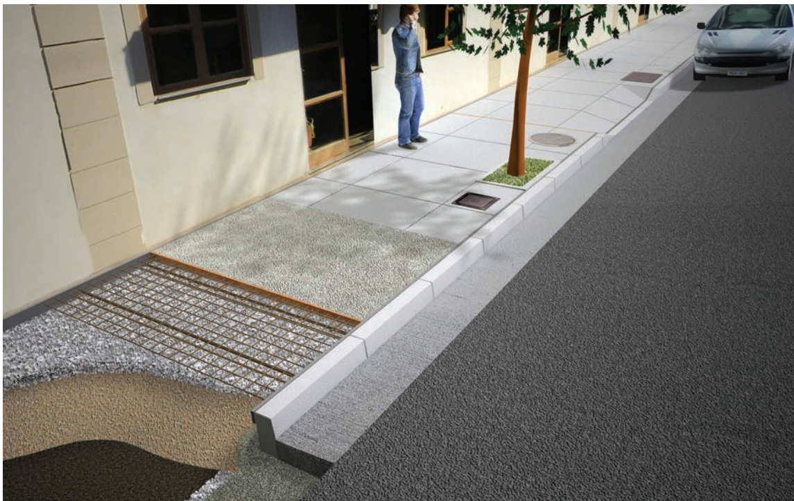
A. CALÇADA EM PAVIMENTO DE CONCRETO MOLDADO “IN LOCO”
