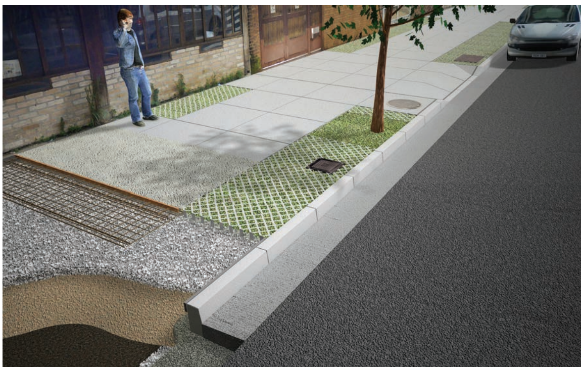
D. CALÇADA EM PAVIMENTO DE CONCRETO MOLDADO “IN LOCO”, COM UTILIZAÇÃO DE BLOCOS DE CONCRETO INTERTRAVADOS VAZADOS (PISO GRAMA OU CONCREGRAMA) JUNTO À FAIXA DE SERVIÇO OU DE ACESSO.
